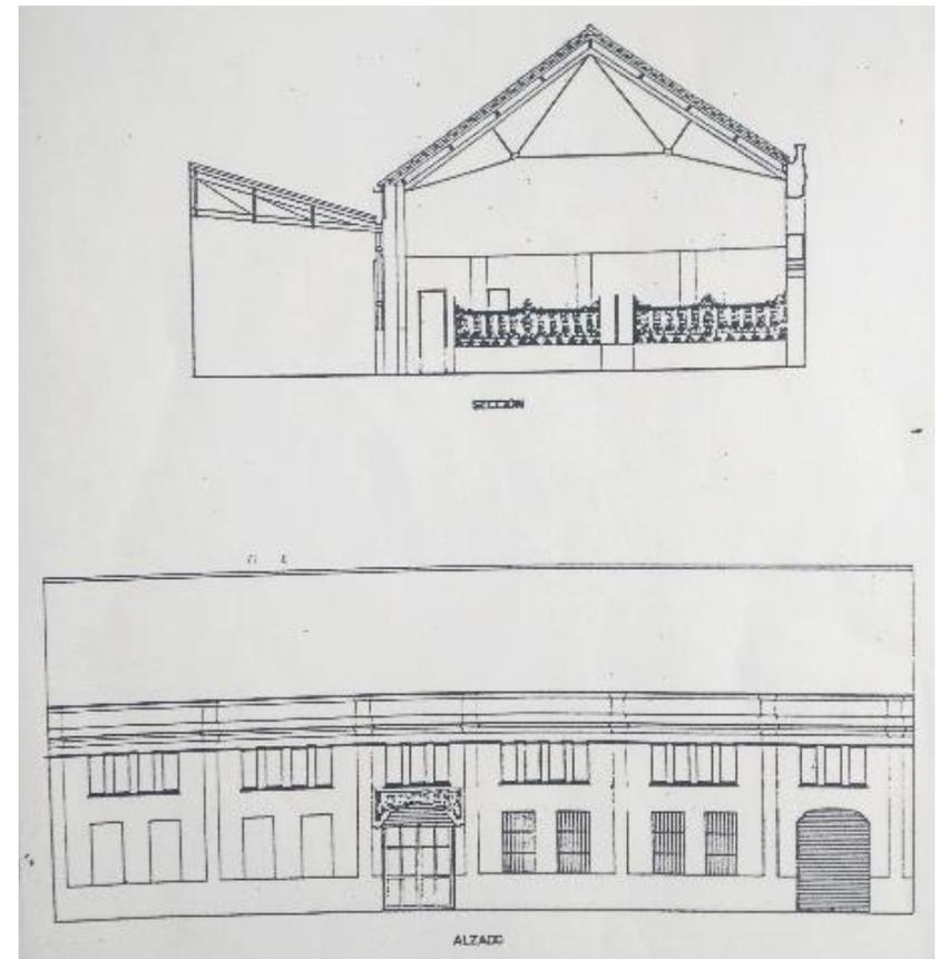
Fig. 23 y 24. Planos de arquitectura, sección transversal y alzado exterior según levantamiento en 1985. Probablemente conserva parte de su distribución original. Fuente: GMU
