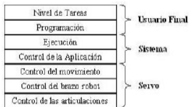
Figura 4. Arquitectura de capas del sistema de control
