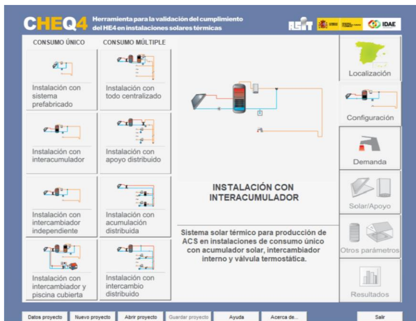
Figura 1.2: Configuración del sistema solar térmico.
