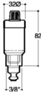
Figura 1.38: Dimensiones purgador de aire BAXI
