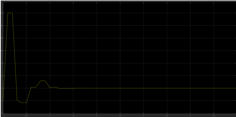
Figura 2.22 Acción de control en Simulink con tiempo de muestreo de 1 segundo en tiempo real.
