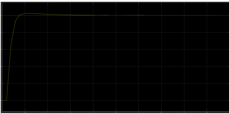
Figura 2.14 Control PI con tiempo de muestreo menor y anti windup.
