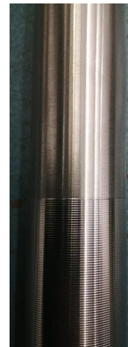
Figura 4.12 Huella por cambio de avance
