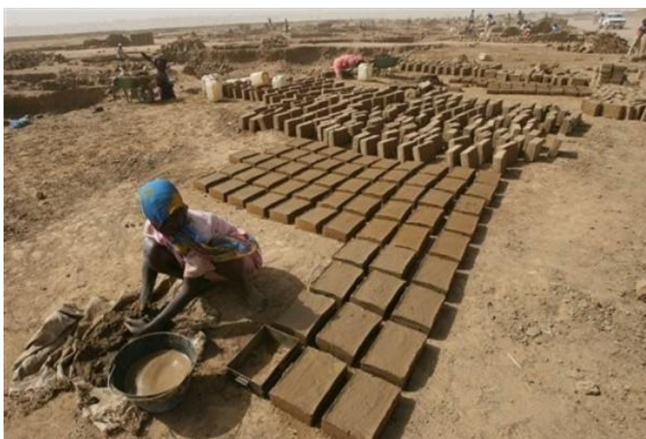
Figura 4. Elaboración de bloques de Adobe y posterior secado
