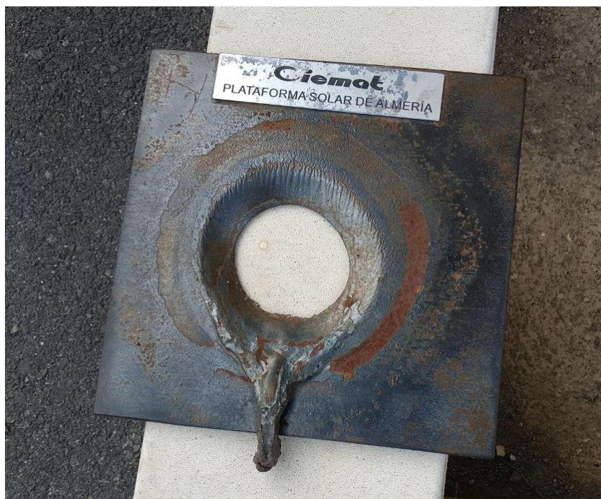
Ilustración 9: Muestra de hierro fundido por horno solar SF-60. Fuente: Elaboración propia.
