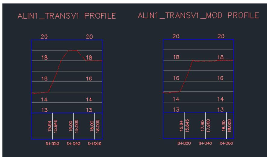
Figura 4.13 Comparación de terreno original (izquierda) con terreno modificado (derecha). Mota 1
