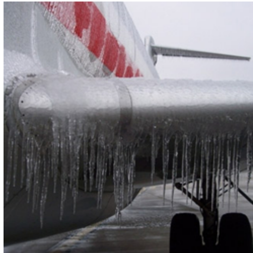
Figura 1.2 Engelamiento en el borde de ataque de un avión.
