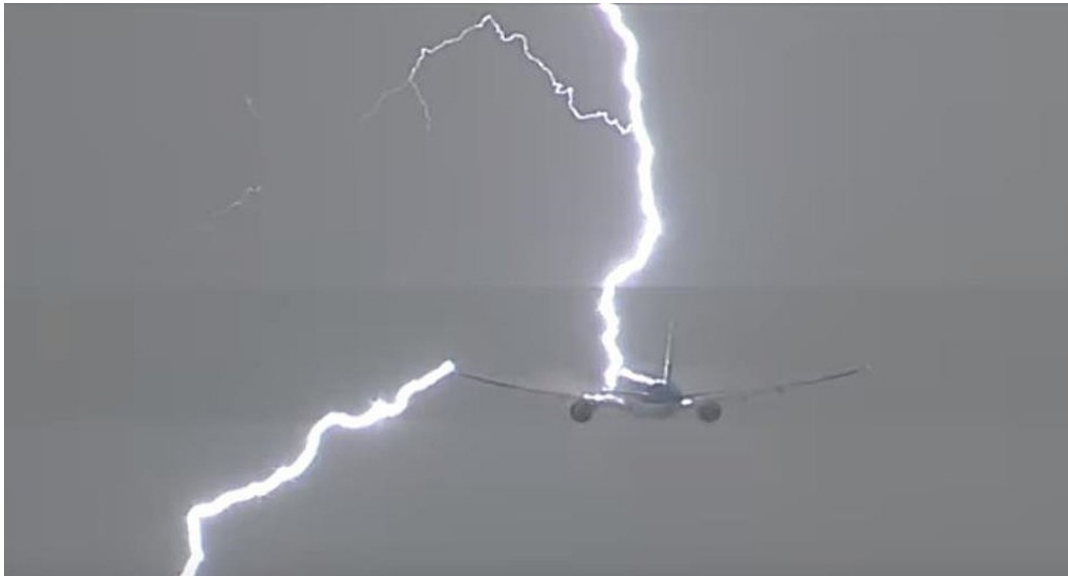
Figura 1.3 Impacto de un rayo sobre una aeronave.
