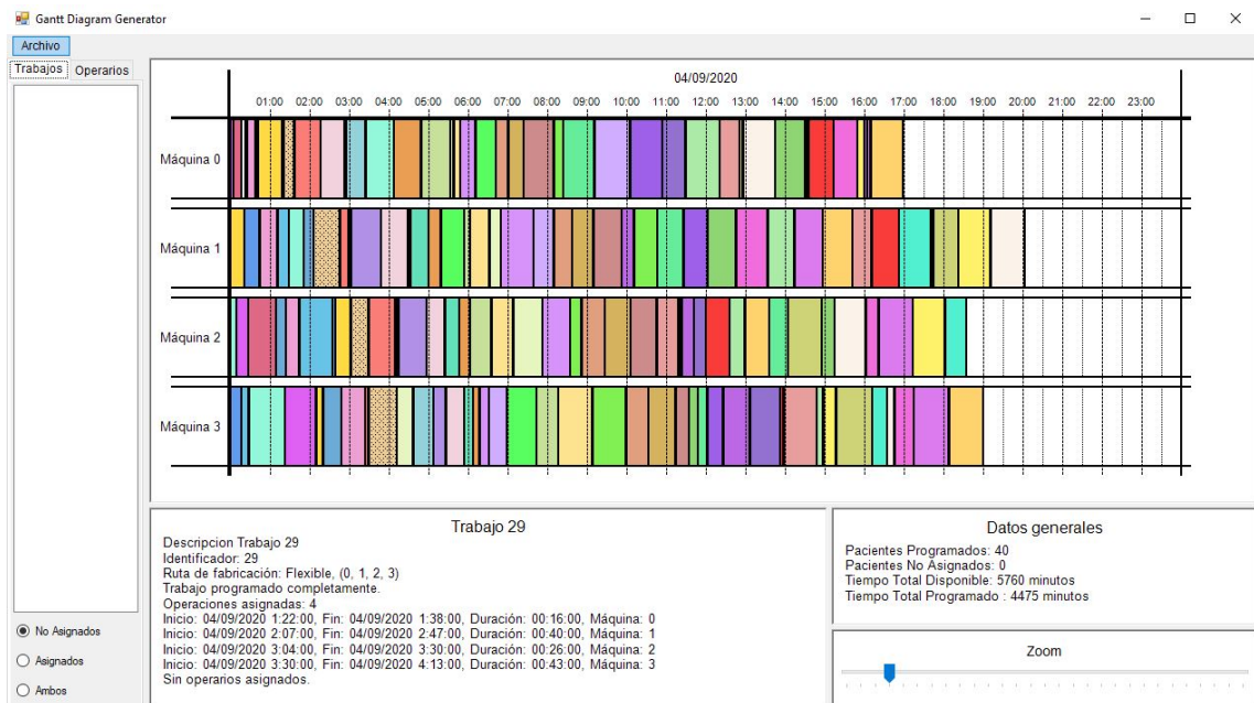
Figura 3.18 Ejemplo de un diagrama de Gantt de un taller abierto producido por la aplicación desarrollada, elaboración propia .
