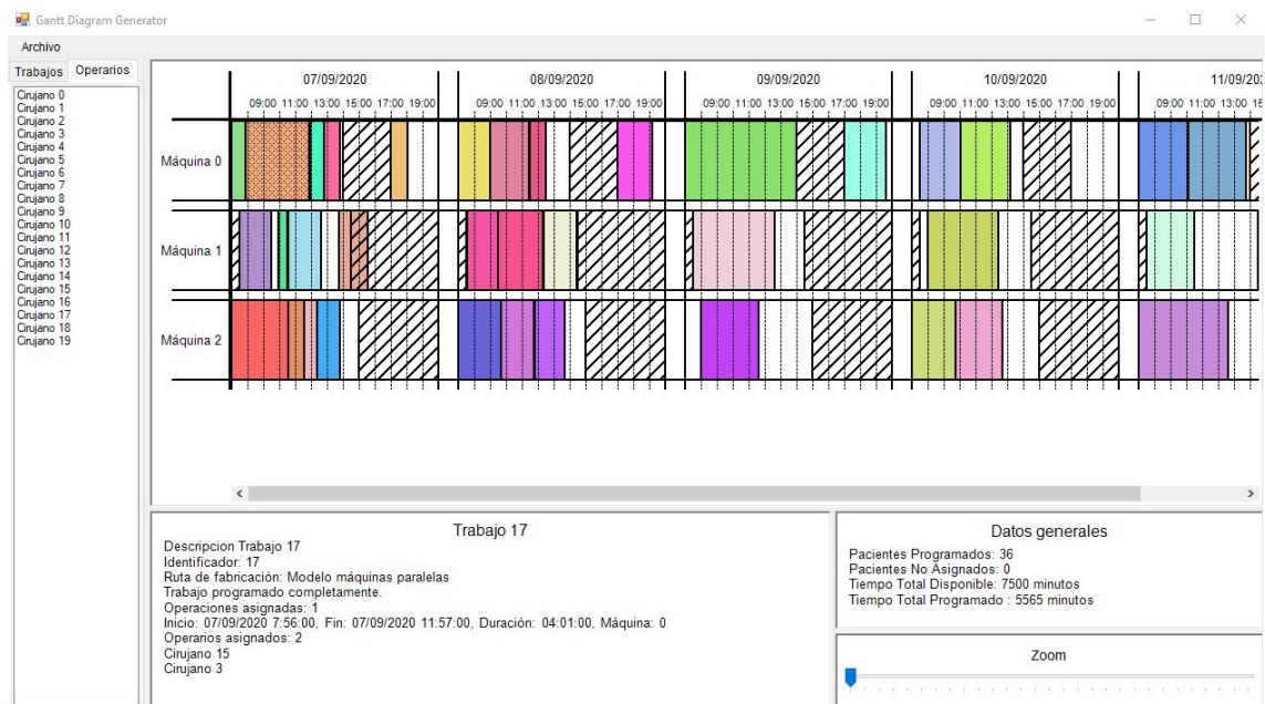
Figura 3.16 Ejemplo de un diagrama de Gantt de un modelo de máquinas paralelas producido por la aplicación desarrollada, elaboración propia .
