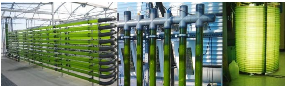
Figura 1.8. De izqda. a dcha.: FBR horizontales, FBR verticales. FBR helicoidales BIOCOIL. Fuente: Valera Callejo, 2018.
