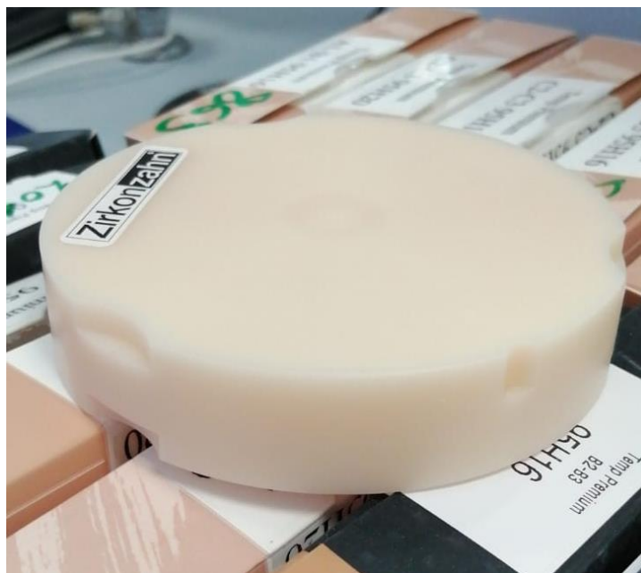
Ilustración 8. Tocho del que se extraen las probetas
