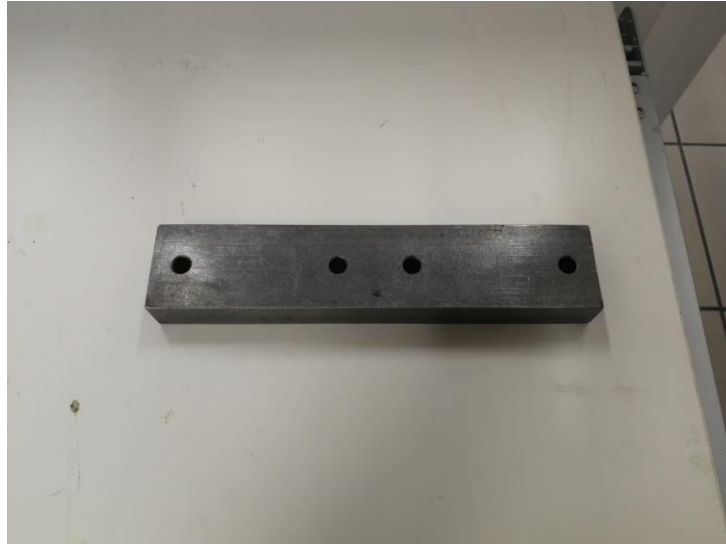
Ilustración 13. Barra de acero usada para la sujeción
