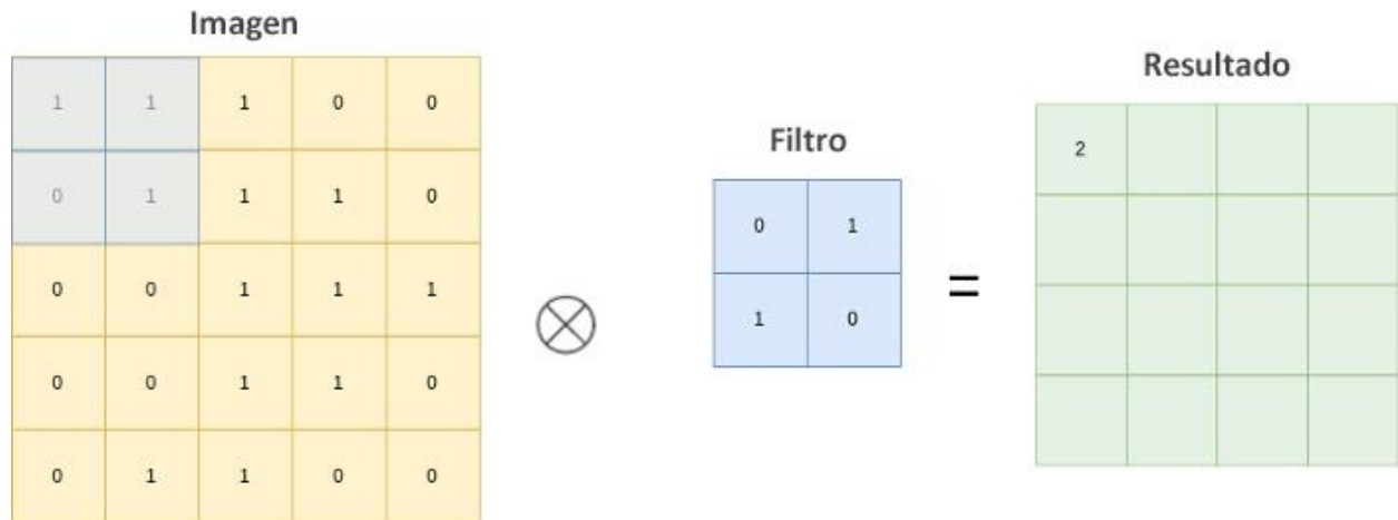
Figura 2-3: Ejemplo de la operación de convolución
