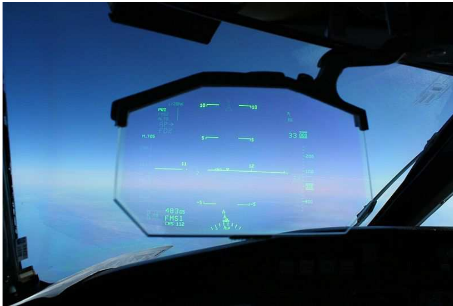
Figura 1-2: HUD empleado en aviación, desde el punto de vista del piloto. (Shawn, 2008)
