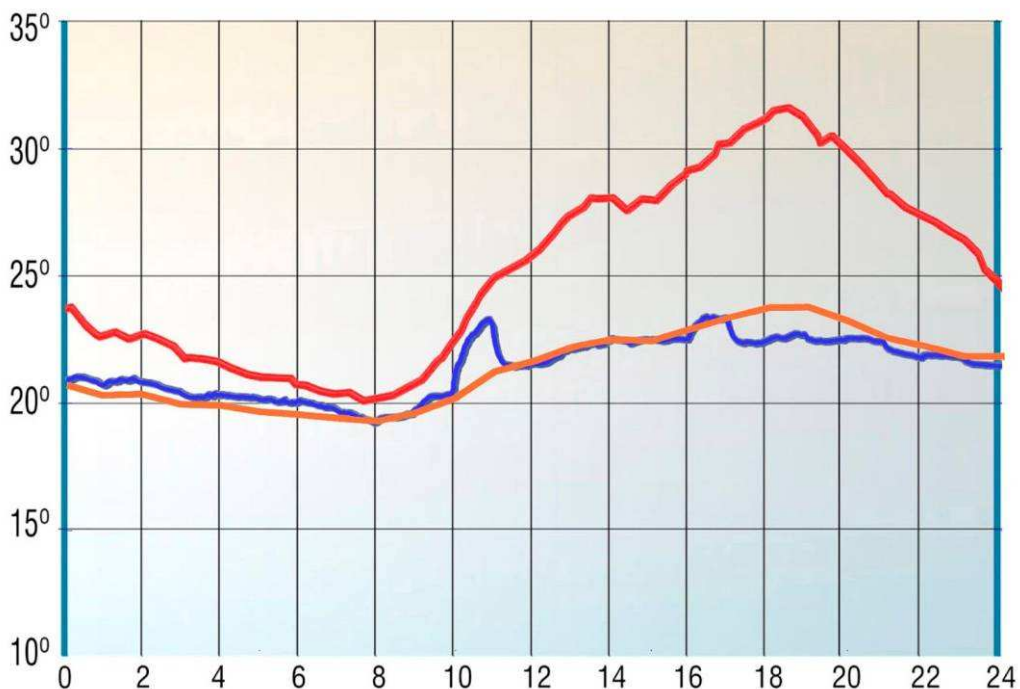
Figura 12. Gráfico comparativo de las temperaturas monitorizadas el día 27/04/2010 en el exterior del edificio, las monitorizadas en el interior del edificio y las calculadas por el modelo numérico generado a partir de las condiciones exteriores reales monitorizadas y la geometría del edificio.
