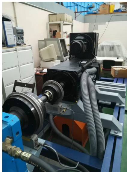
Figura 1. Banco de ensayos (Motor eléctrico y torsiómetro de entrada)
