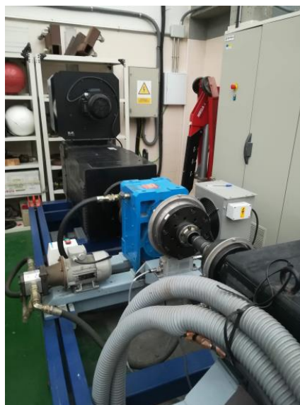
Figura 2. Banco de ensayos (Torsiómetro de salida, reductora adicional y freno motor)
