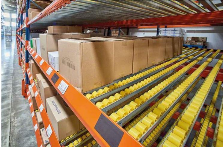
Figura 6-3 Almacenamiento Alta Rotación (Mecalux, s.f.)
