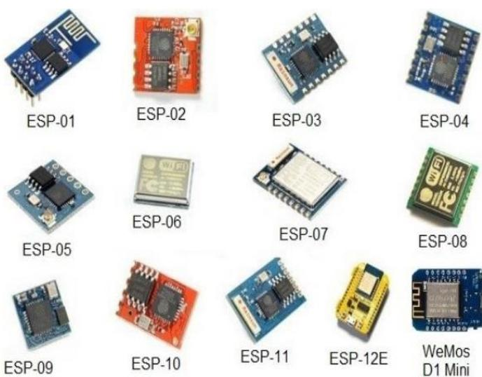
Imagen 9: Modelos de microcontroladores ESP8266. Fuente: Arjadi, R. Harry, et al.(2018).
