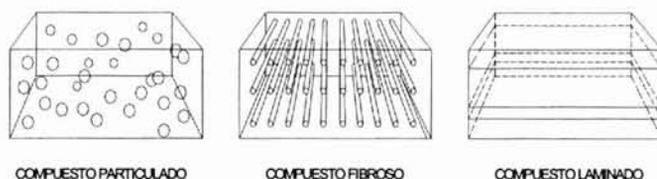
Figura 1.- Tipos de Materiales Compuestos.
