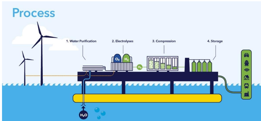
Ilustración 25: Esquema básico de la unidad de producción de hidrógeno – Proyecto Jidai [58].
