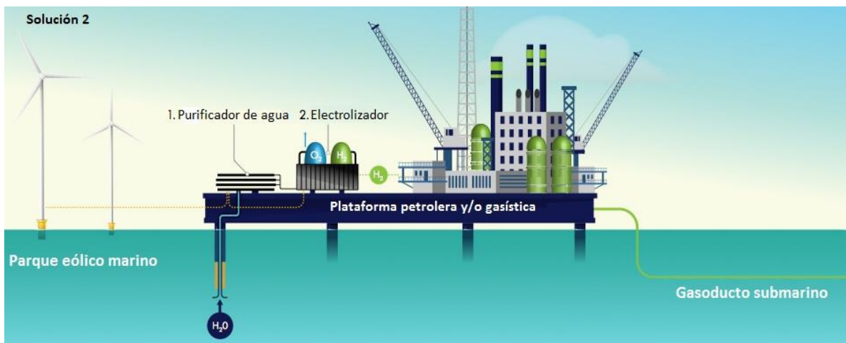
Ilustración 24: Solución 2 para la instalación de una planta de producción de hidrógeno offshore [54].
