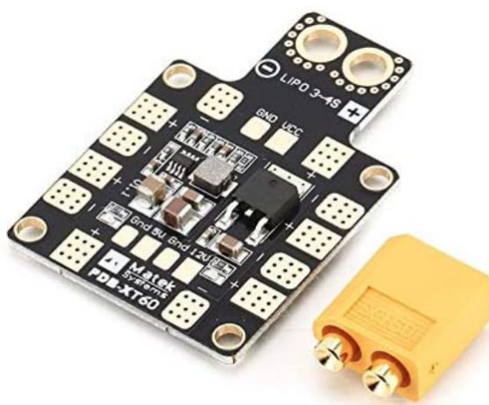
Figura 6-31 Placa de distribución de potencia
