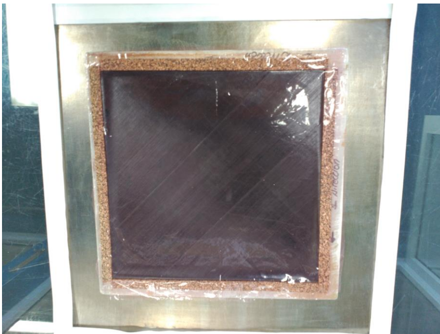
Figura 3-9: Capa de teflón colocada encima del laminado
