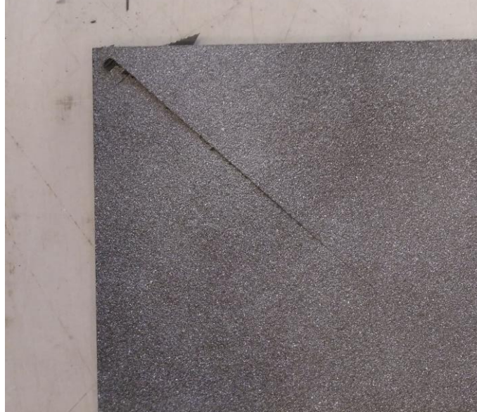
Figura 5-25: Detalle de la rotura del laminado 12
