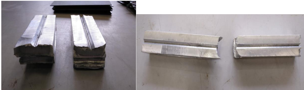
Figura 4-7: Rotura del útil de ensayo
