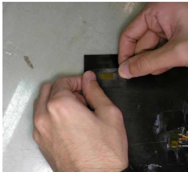
Figura 4-3: Pegado de la cinta con la banda al panel
