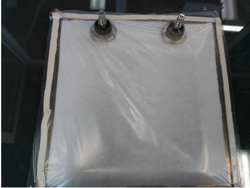
Figura 3-11: Bolsa de vacío completamente cerrada
