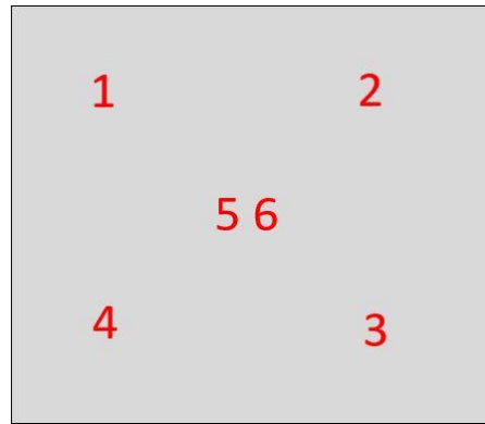
Figura 6-18: Colocación de las galgas en el panel
