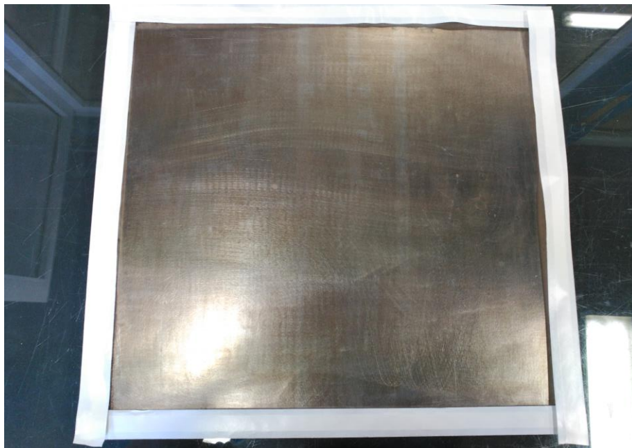
Figura 3-7: Plancha con las bandas de cromato
