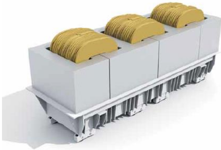
Fig. 3: Núcleo acorazado o “ shell type ”
