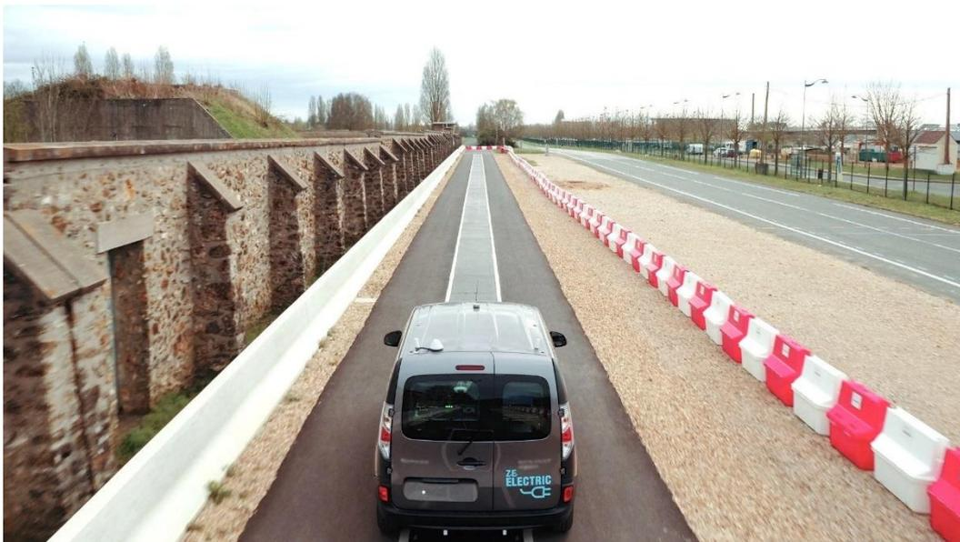
Figura 3-3: Sistema de carga inductiva dinámica aplicado a un vehículo [32].
