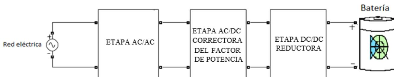
Figura 4-1. Diagrama de bloques general del cargador a diseñar.
