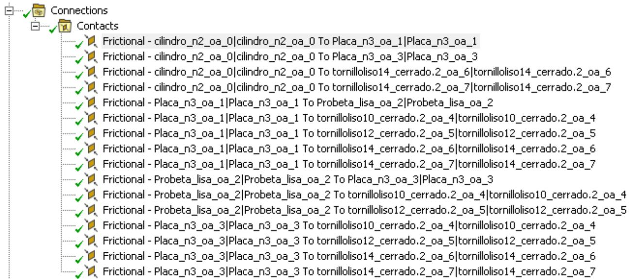
Figura 3-9. Definición de todos los contactos en ANSYS.
