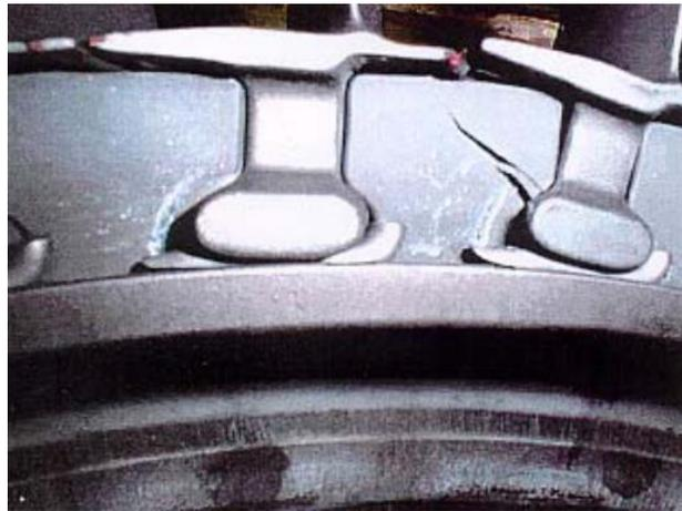
Figura 1-1.- Turbina dañada por fretting [2].
