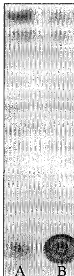
Figura 4.1. C.c.f del cultivo inducido con genisteína marcado con ^{14}\text{C} -glucosamina (A) y con \text{Mg}^{35}\text{SO}_4 (B)
