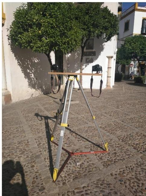
**Figura 9.** “Instrumental utilizado para la realización de la sesión estereoscópica”.
