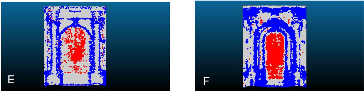
**Figura 25.** “Pruebas E y F. Clasificación mediante Canupo. Los puntos rojos representan a la madera mientras que los azules representan el mármol”. Imagen del autor
