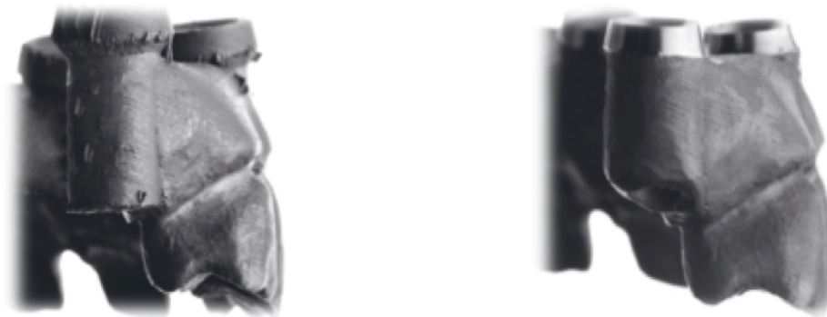
Fig.1. Estructura impresa en metal para prótesis sobre implantes, fabricado con tecnología SLM con posterior mecanizado de la interfase del implante. (24)
