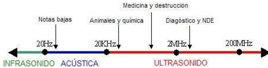
**Ilustración 1: Clasificación de ondas de sonido**
