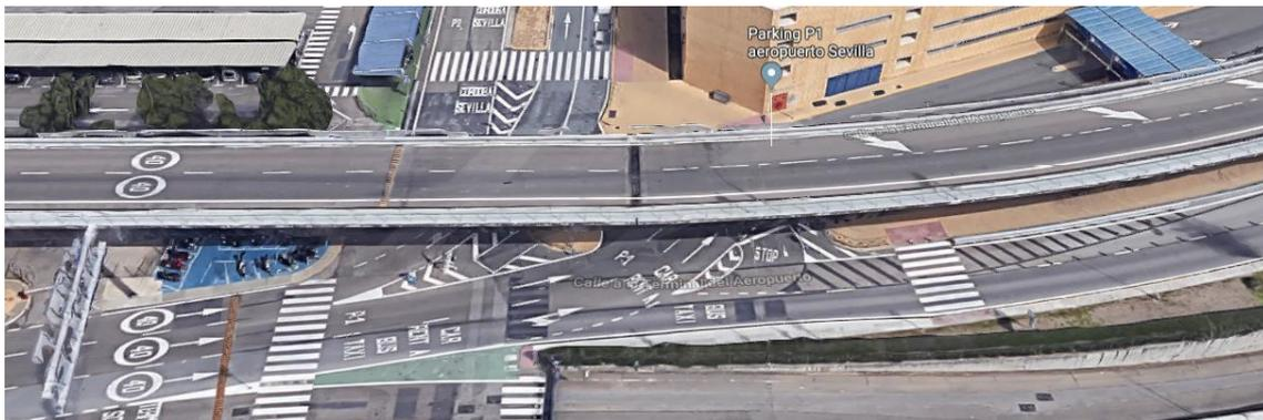
Figura 8-6. Vista en planta del acceso por carretera a la terminal de salidas (carretera nivel superior) y de llegadas (carretera nivel inferior) (Fuente: Google Maps)
