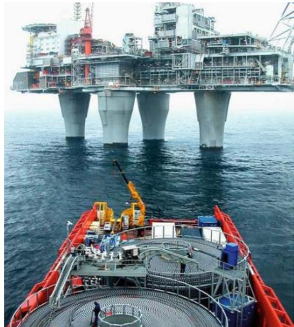
Figura 2. Instalación del cable de suministro de una planta petrolífera [3]
