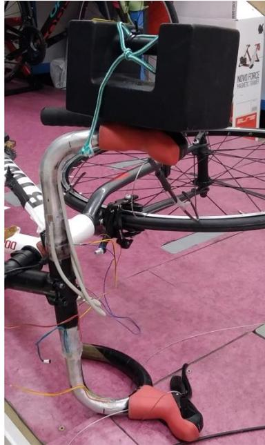
Figura 24. Imagen de la calibración en el eje Z. Imagen de elaboración propia.
