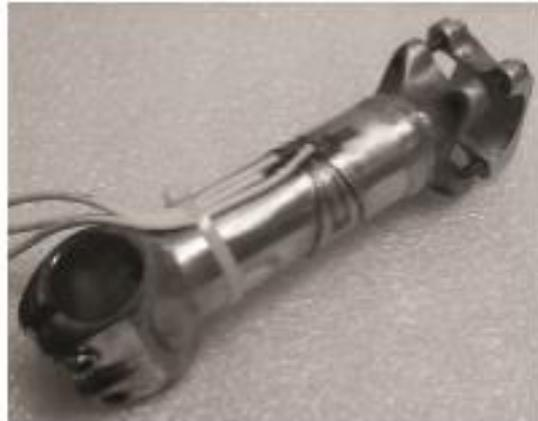
Figura 6. Imagen del vástago del manillar instrumentado. Imagen obtenida del documento J.M. Drouet et al., 2012.
