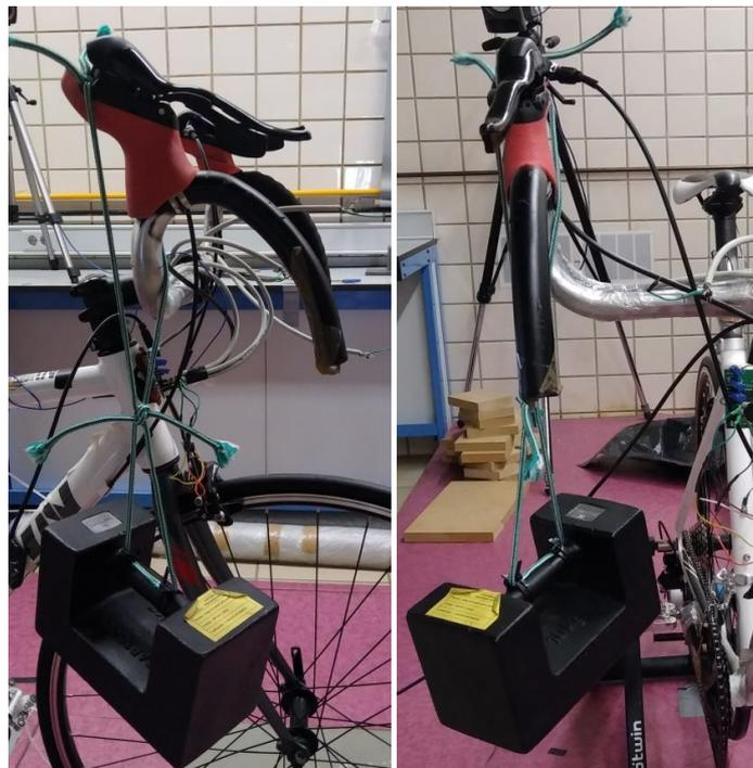
Figura 23. Imágenes de la calibración en el eje Y. Imagen de elaboración propia.
