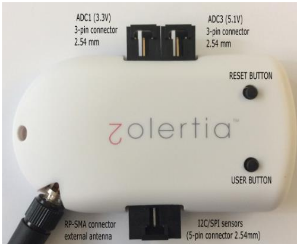
Figura 8. Pinout de la plataforma RE-Mote revisión b (de (4)).
