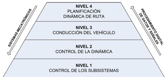
Figura 1. Niveles de control de un RMA.
