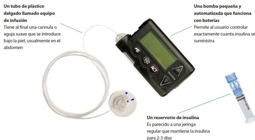
Figura 5. Elementos de una bomba de insulina (disponible en: https://www.medtronicdiabeteslatino.com/proveedores-de-salud/bomba-de-insulina ).
