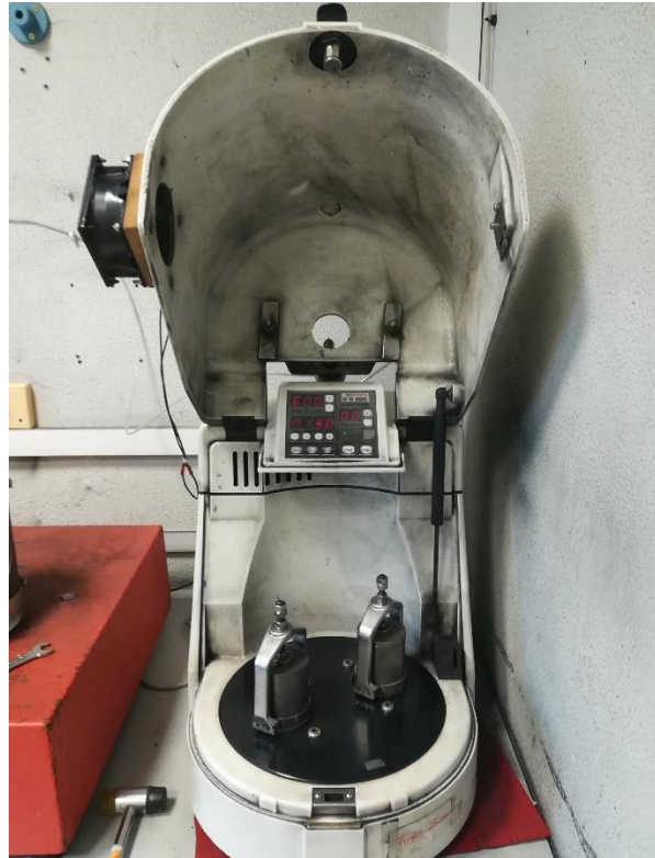
Figura 3.8: Molino planetario de bolas de alta energía Pulverisette P7, Fritsch.
