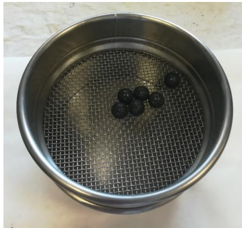
Figura 3.4: Tamiz utilizado para separar la muestra en polvo de las bolas del jarro.
