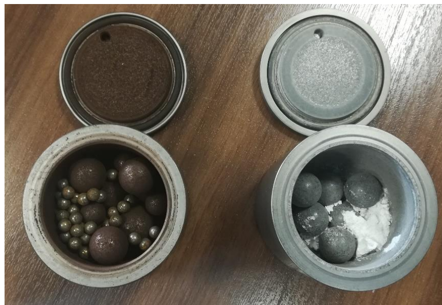
Figura 3.3: Jarro de acero con bolas de WC junto con los reactivos utilizados en la molienda reactiva (dcha.) y jarro y bolas de acero utilizado como contrapeso (izda.).
