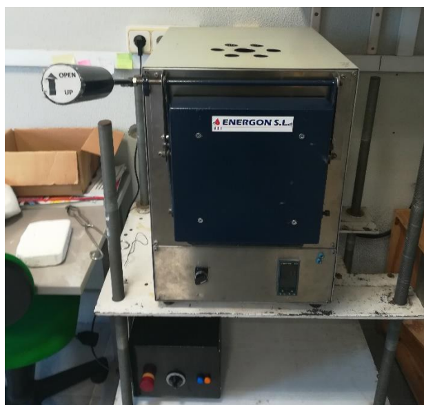
Figura 3.1: Horno mufla usado para los tratamientos térmicos de los reactivos.
