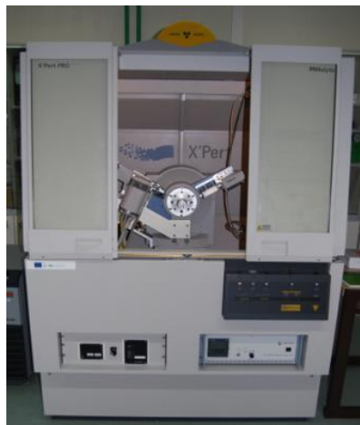
Figura 3.12: Difractómetro rayos-X Philips X'Pert Pro.
