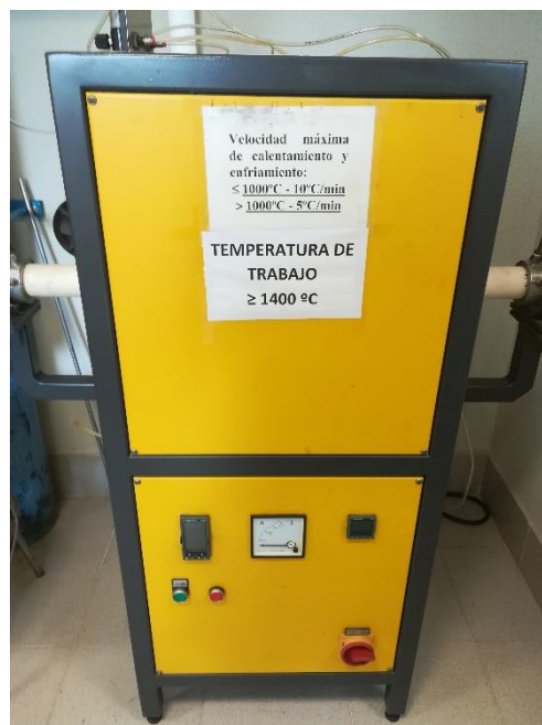
Figura 3.7: Horno tubular utilizado para la sinterización de las muestras en polvo.
