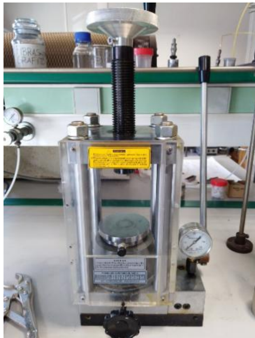
Figura 3.5: Prensa isostática en frío.
