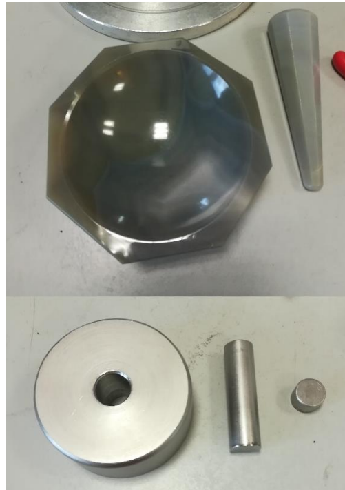
Figura 3.6: Mortero de ágata y matriz usados para el conformado de las muestras en polvo.
