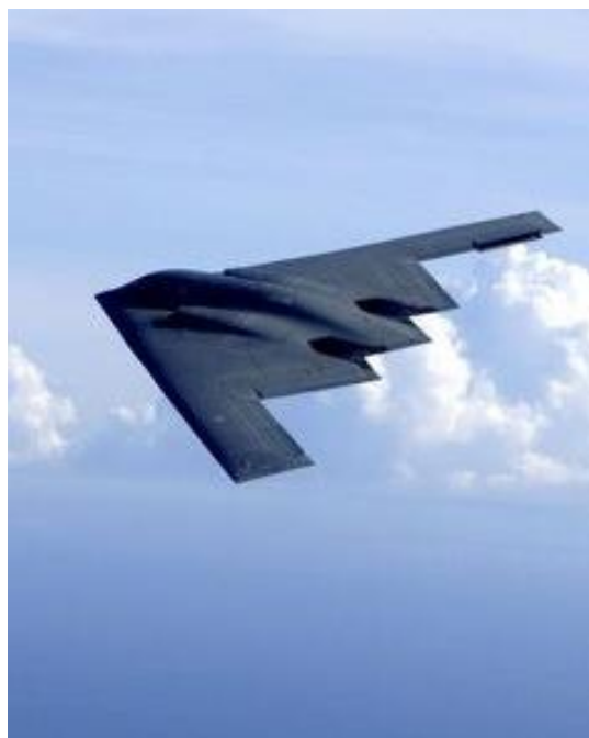
Figura 1-3. Bombardero B2, hecho en su totalidad de materiales compuestos.
