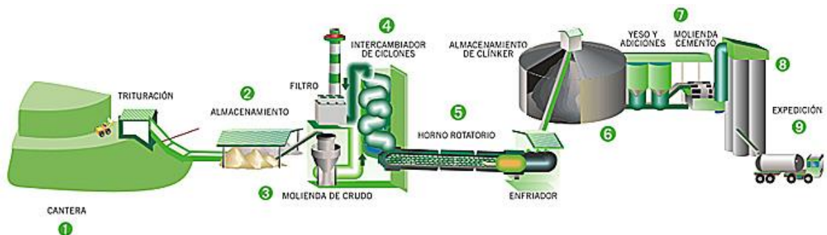
Fig.50. Proceso fabricación hormigón
