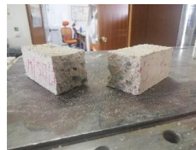
Fig. 26. Rotura probeta 1,3% (EP)
