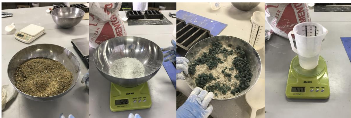
Fig. 17. Materiales para mezcla Mortero de cemento y Fibras poliamidas (EP)
