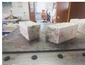
Fig. 25. Rotura probeta 0,6% (EP)
