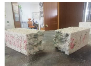
Fig. 27. Rotura probeta 1,6% (EP)
