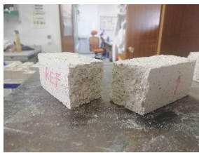
Fig. 24. Rotura probeta 0% (EP)
