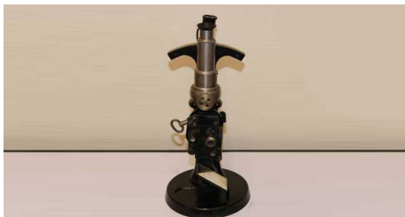
Figura 3. Refractómetro de Abbe perteneciente al Museo de Historia de la Facultad de Farmacia. Universidad de Sevilla. 70
