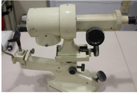
Figura 17. Queratómetro de Helmholtz Marca BOBES perteneciente a la empresa Oftálmica Instruments SL. 98
