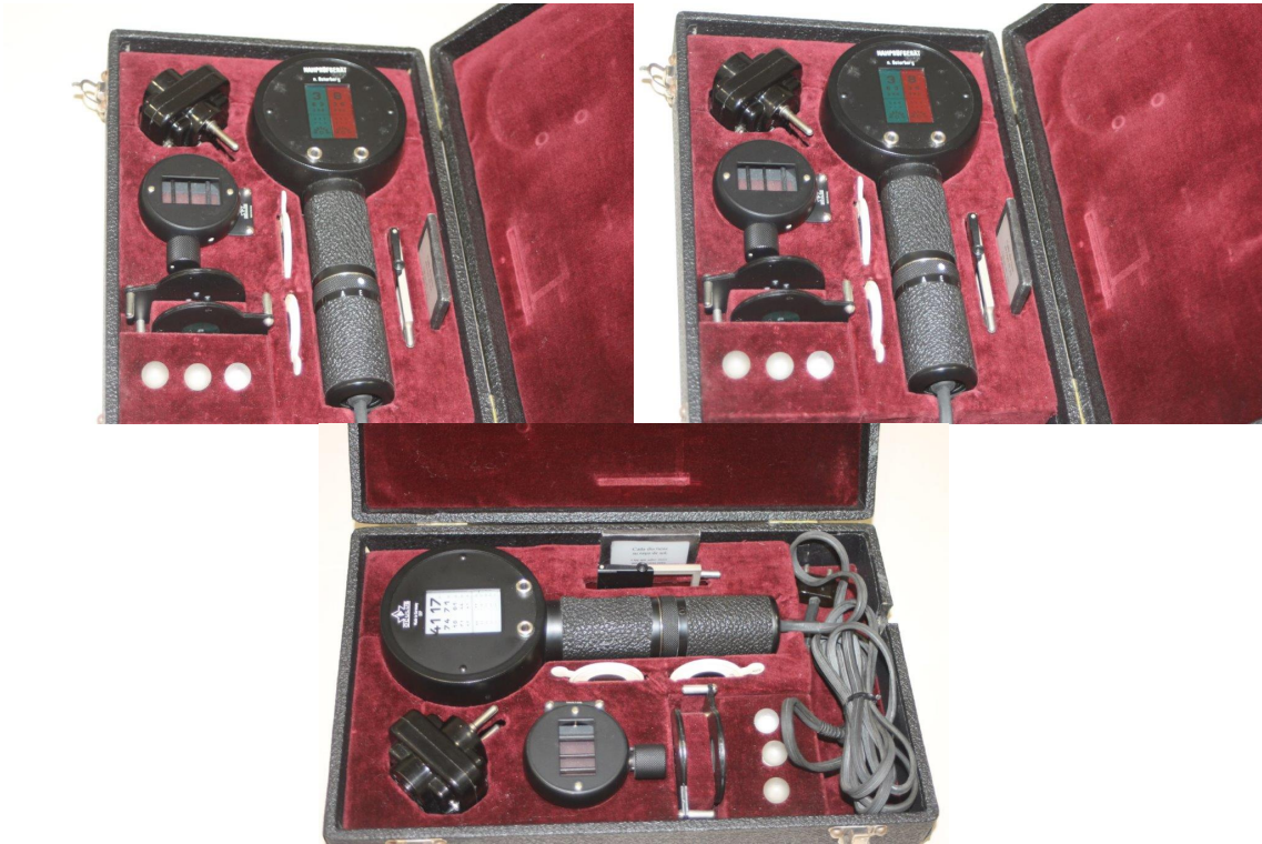
Figura 21. Test de Visión Cercana Marca Oculus perteneciente a la empresa Oftálmica Instruments SL. 105
