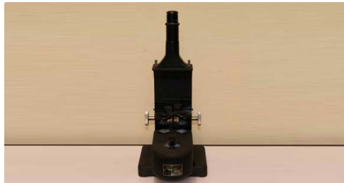
Figura 2. Colorímetro de Duboscq perteneciente al Museo de Historia de la Facultad de Farmacia. Universidad de Sevilla. 68
