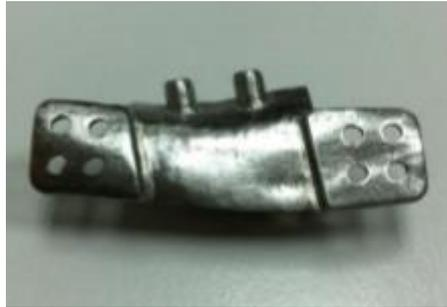
*Figura 14.* Implante mandibular parcial de Ti fabricado mediante tecnología 3D. (Huang et al., 2019)
