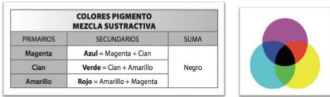
Figura 7: colores-pigmento translucidos primarios: magenta, amarillo y cian. Se observa que al revés de los colores-luz, los colores pigmento opacos y translúcidos son regidos por el sistema de resta de luz. Como resultado, la mezcla de los colores primarios resulta en gris neutro o negro (Soldevilla, 2014).
