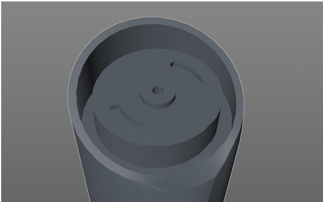
Figura 3.9 - Detalle torre (motor insertado en ella)
