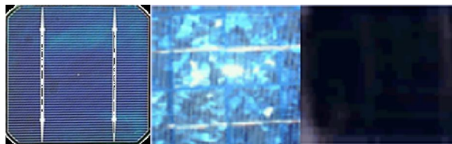
Figura 3-2. Silicio monocristalino, policristalino y amorfo (de izquierda a derecha)[38]
