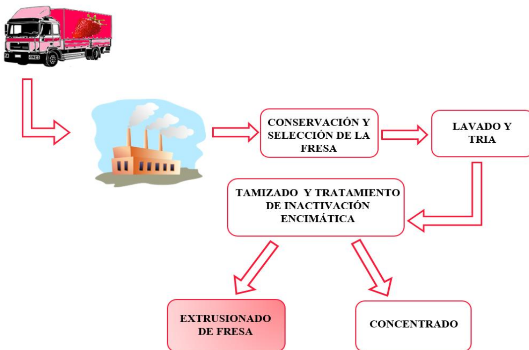
Figura 3. Esquema de obtención del EFR.
