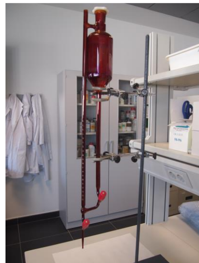
Figura 19. Digestor de las muestras de DQO_{\text{soluble}} . Figura 20. Bureta de valoración de la DQO_{\text{total}}
