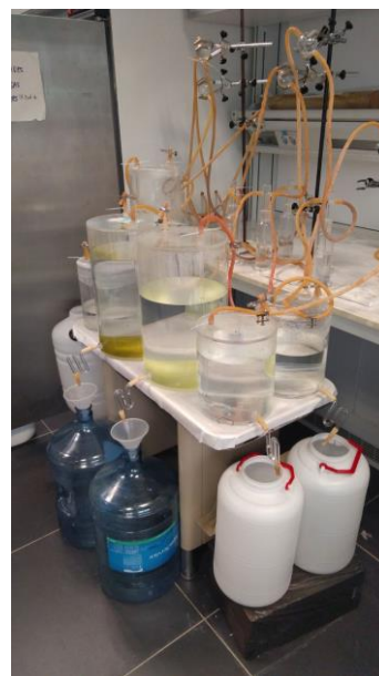
Figura 15. Borbotadores y gasómetros medidores de biogás
