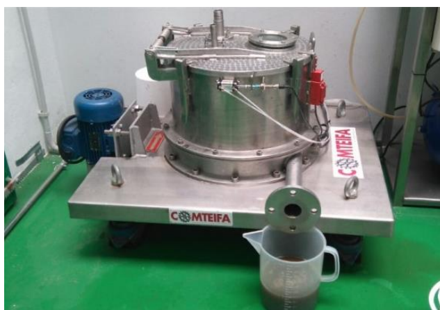
Figura 10. Centrifuga de eje vertical.
