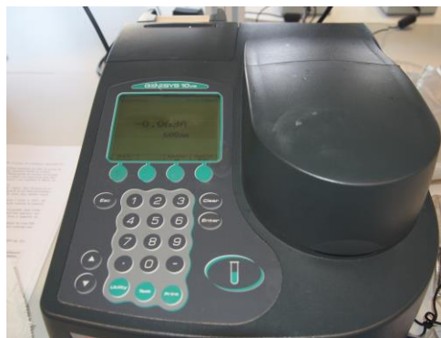
Figura 21. Espectrofotómetro para la determinación de la DQO_{\text{soluble}} .
