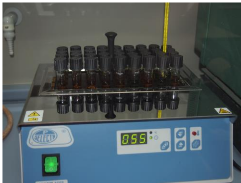
Figura 19. Digestor de las muestras de DQO_{\text{soluble}} . Figura 20. Bureta de valoración de la DQO_{\text{total}}
