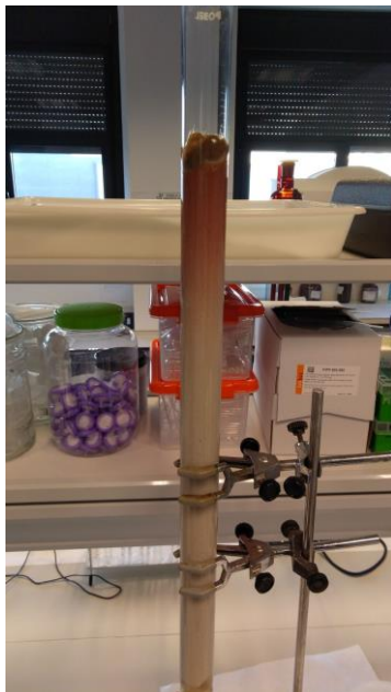
Figura 11. Columna de extracción de fenoles
