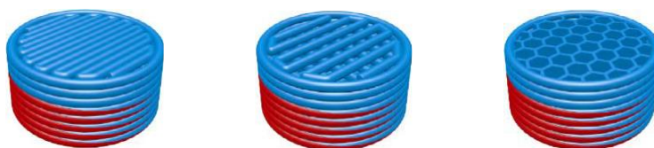
Figura 15. Sistemas bicompartimentales con porcentajes de relleno de 100, 50 y 25%, respectivamente (Jamróz et al., 2020).
