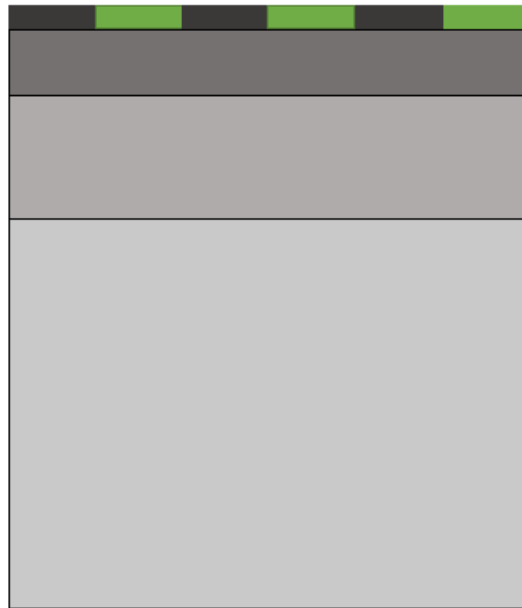
Figura 3-22. Pavimento con variación geométrica de la superficie heterogénea.
