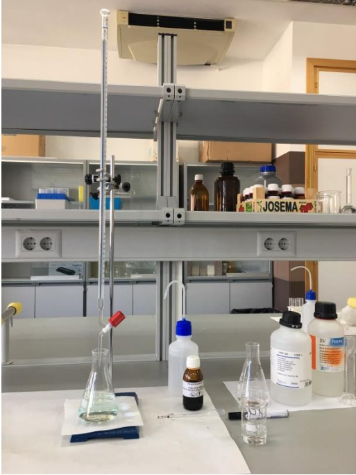
Figuras 9 y 10. Valoración del borato amónico con ácido clorhídrico
