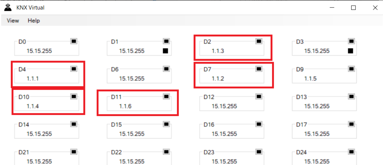
Figura 34 Captura de KNX virtual con sus dispositivos programados
