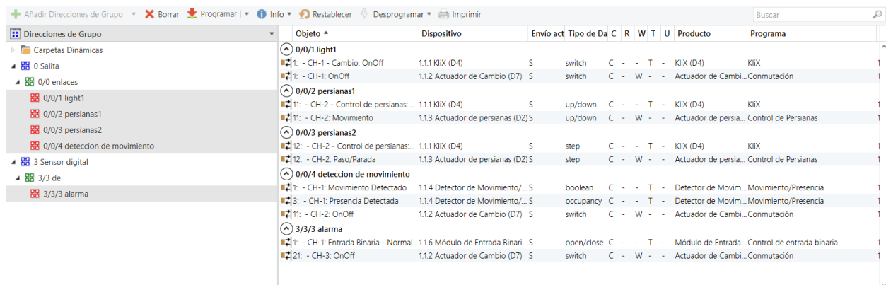
Figura 33 Enlaces de los aparatos virtuales con sus direcciones de grupo
