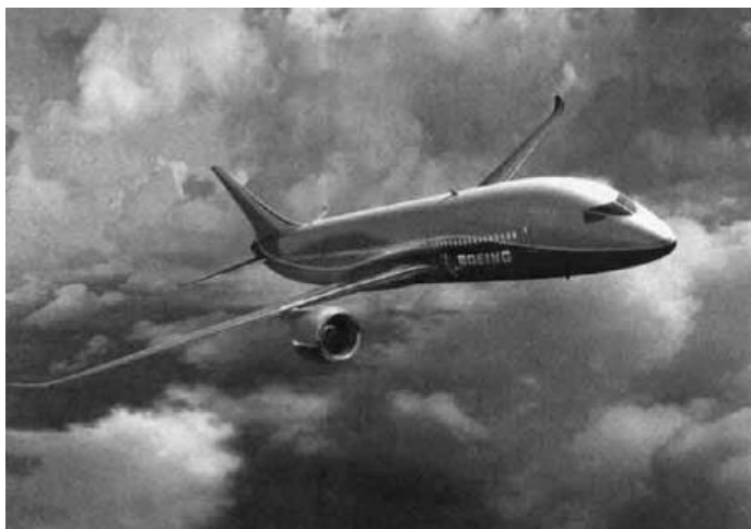
Figura 1-3. Boeing 787 "Dreamliner", mayoría del fuselaje y alas hechas de materiales compuestos [1].
